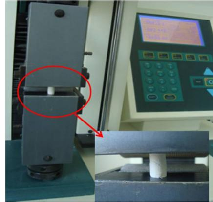
**Figure 2: Echantillon placé sur le plateau inférieur de l'appareil de compression. Le plateau supérieur descend à une vitesse de 1mm/min.**
